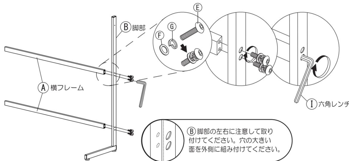
3 同様に反対側の②脚部を取り付けます。⑨六角レンチを使い、⑦スプリングワッシャー・⑥ワッシャーが付いた⑤トラスボルトで①横フレームを緩めに取り付けてください。
