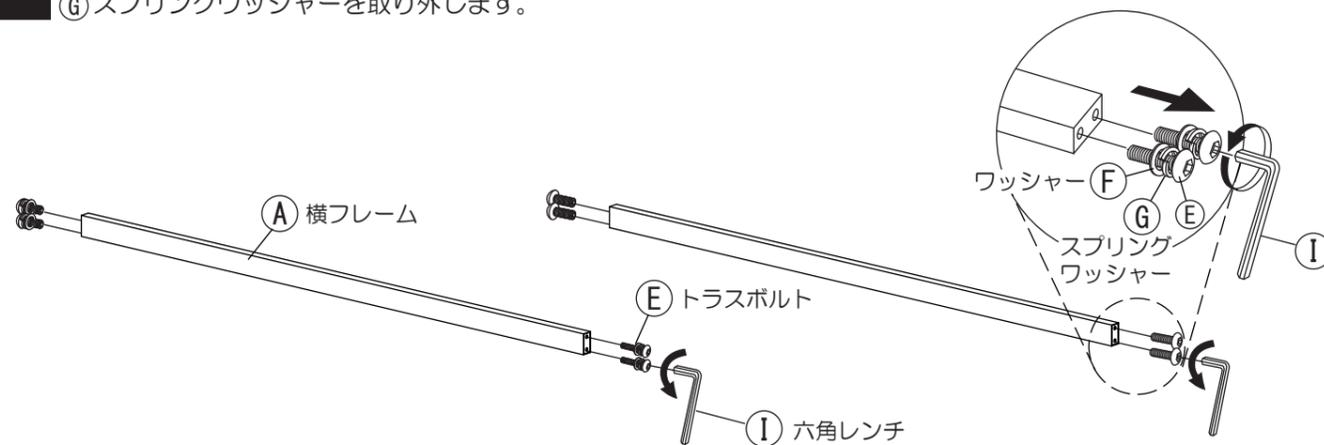
**2** ②脚部に①六角レンチで①横フレームを取り付けます。⑥ワッシャー、⑦スプリングワッシャーが付いた⑤トラスボルトで仮締めしてください。
