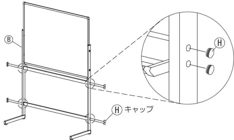
6 必ず商品の背面が、壁面に接するように設置し、アジャスターを回してガタつきがないように調整してください。
