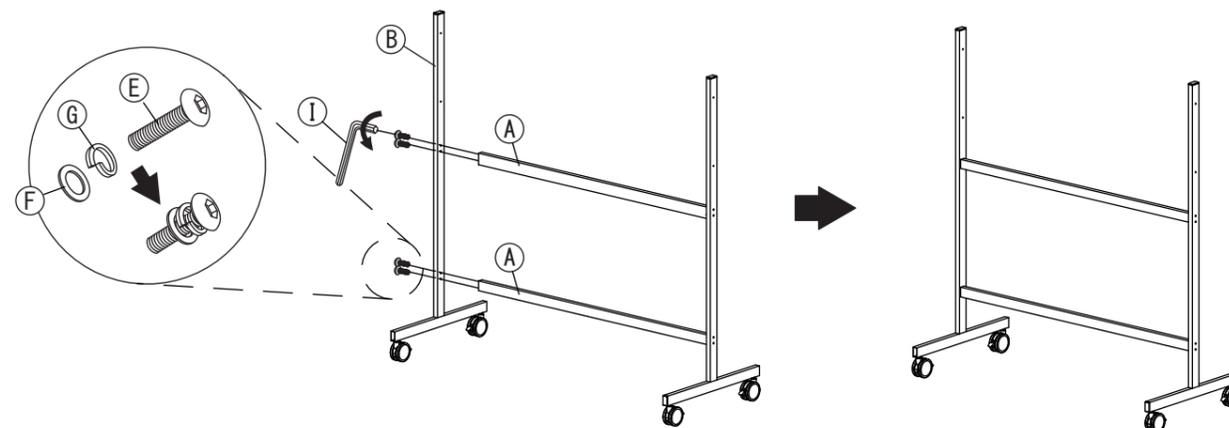
4 **3**で組み立てた脚部に**③**ボードを**④**長ネジでプラスドライバーを使ってしっかりと取り付けます。その後、全ての**⑤**トラスボルトを**①**六角レンチでしっかりと増し締めしてください。
