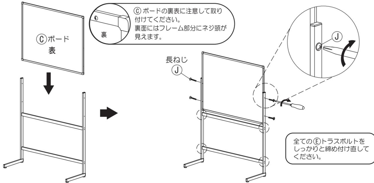
5 全てのネジ類がしっかりと締め付けられていることを確認したら、**⑥**脚部の**⑤**トラスボルトを締め付けた穴に、**⑧**キャップを差し込んでください。
