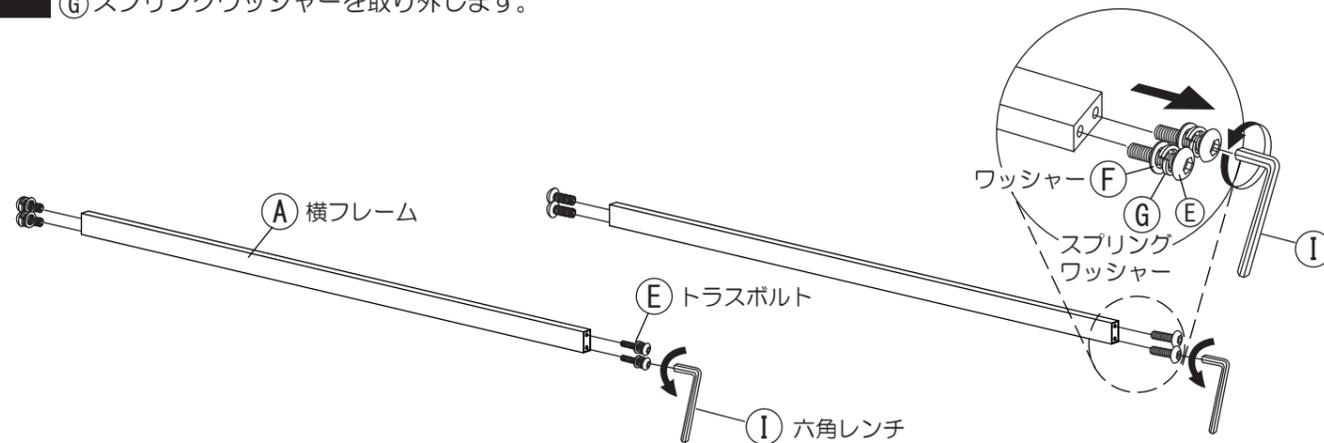
2 ②脚部に⑨六角レンチで①横フレームを取り付けます。⑥ワッシャー、⑦スプリングワッシャーが付いた⑤トラスボルトで仮締めしてください。
