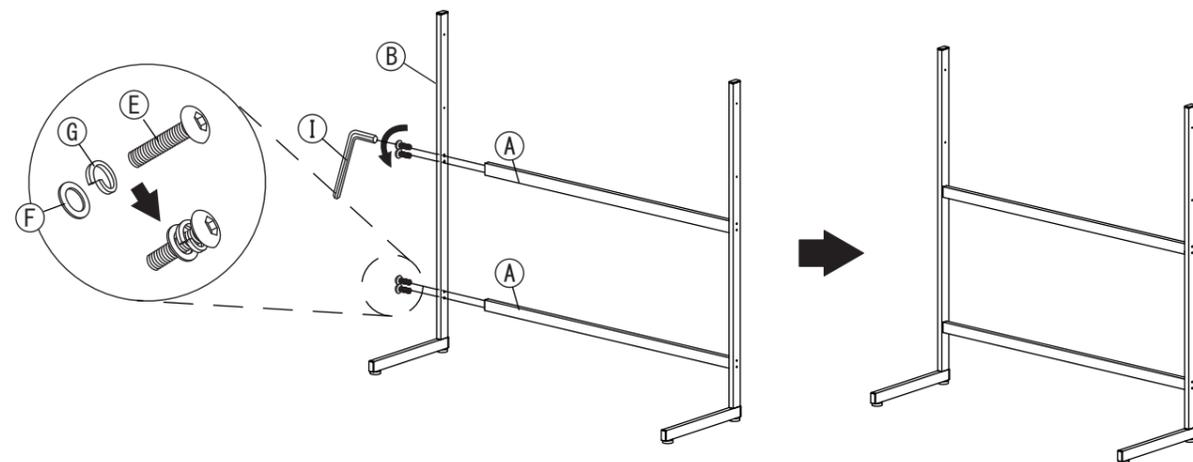
4 **3**で組み立てた脚部に**④**ボードを**①**長ネジでプラスドライバーを使ってしっかりと取り付けます。その後、全ての**⑤**トラスボルトを**①**六角レンチでしっかりと増し締めしてください。
