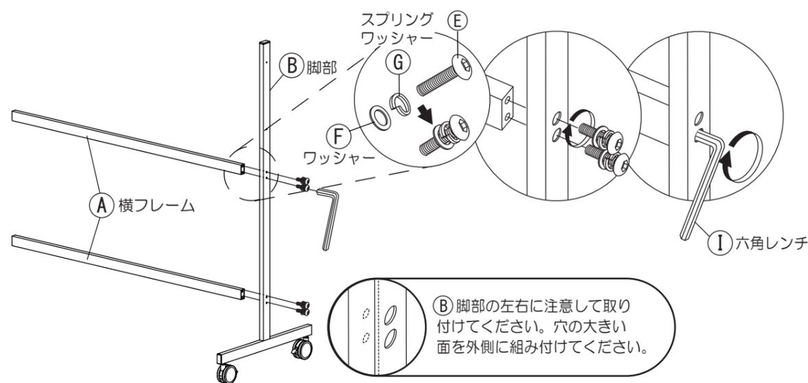
**3** 同様に反対側の②脚部を取り付けます。①六角レンチを使い、⑦スプリングワッシャー・⑥ワッシャーが付いた⑤トラスボルトで①横フレームを緩めに取り付けてください。
