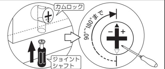
ジョイントシャフトを板の横穴に差し込み、図のようにドライバーでカムロックを締め付けます。この時必ず90度~180度の範囲で締め付けてください。無理に回すと破損の原因となりますのでご注意ください。
