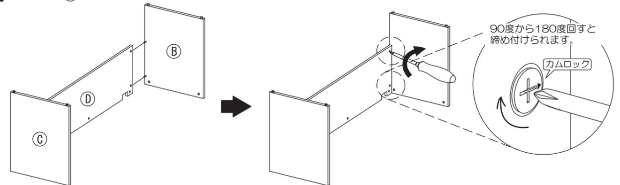
4 ①天板のジョイントシャフトに③で組み付けた本体を差し込みます。その後、左右側板・④幕板のカムロックを締め付けてください。
